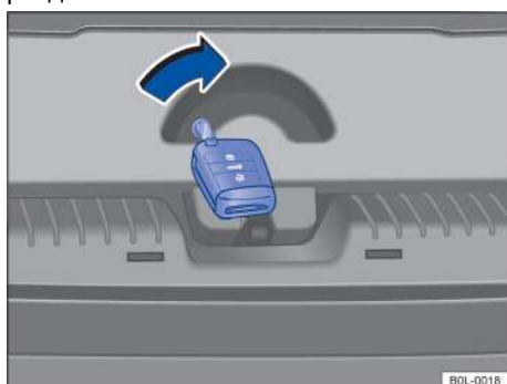
Рисунок 48. В багажнике: отпирание замка багажника
