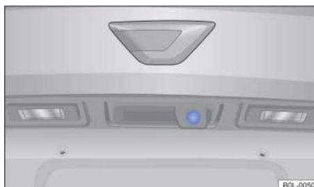
Рисунок 156. На двери багажника: камера обзора заднего вида ▶
