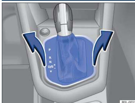
Рисунок 87. Снятие крышки слота переключения передач
