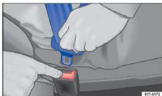
Рисунок 23. Высвободите язычок замка из замка ремня безопасности
