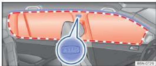
Рисунок 30. Левая сторона автомобиля: положение установки и диапазон раскрытия подушки безопасности для головы
