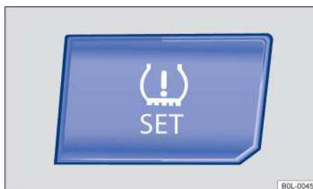
Рисунок 142. Центральная консоль: кнопка контроля давления в шинах
