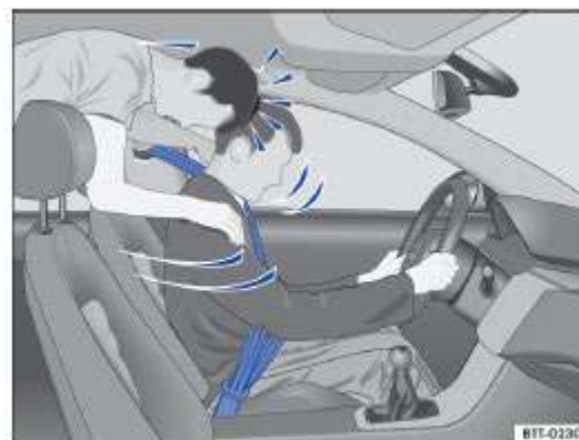
Рисунок 20. Пассажир на заднем сиденье, не пристегнутый ремнем безопасности, будет выброшен вперед к пристегнутому ремнем водителю
