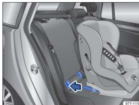
Рисунок 34 Схематическое изображение: установка детского кресла Isofix с удерживающими рычагами
