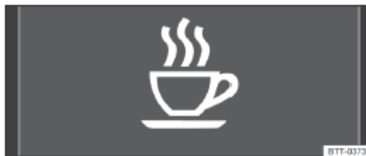
Рисунок 10. Экран дисплея приборной панели: Предупреждающий символ о необходимости остановки для отдыха
