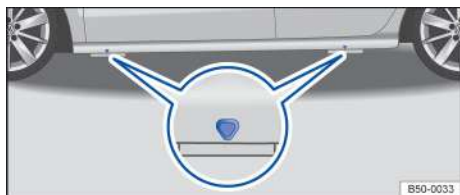
Рисунок 152. Точка опоры автомобильного домкрата
