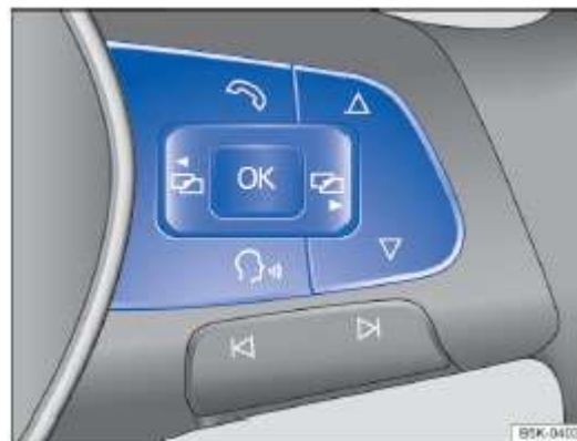
Рисунок 14. Правая сторона многофункционального рулевого колеса: клавиши управления меню приборной панели и информационного дисплея (данный рисунок приведен только в качестве примера)
