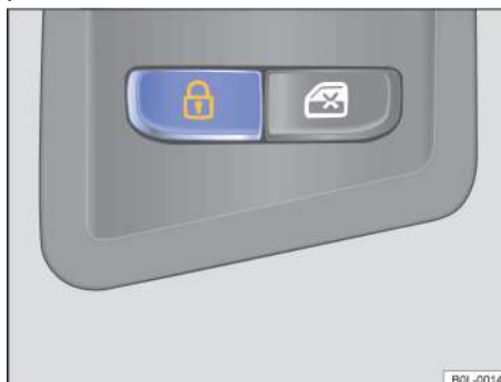
Рисунок 41. На двери водителя: кнопка управления центральным замком
