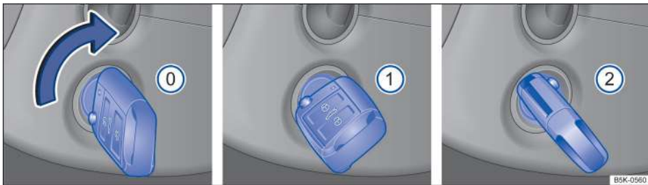
Рисунок 80 Правая сторона рулевой колонки: расположение ключа автомобиля в замке зажигания
