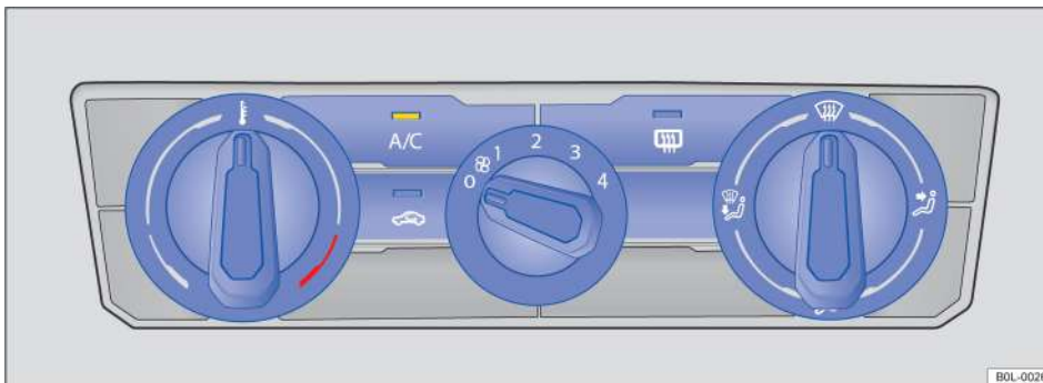
Рисунок 74. Верхняя часть консоли: Панель управления полуавтоматической системой кондиционирования воздуха
