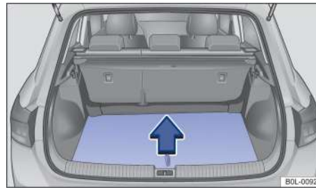
Рисунок 114. В багажнике: Открывание пола багажника
