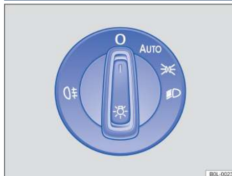
Рисунок 62. Рядом с рулевым колесом: выключатель ламп (данный тип приведен только в качестве примера)
