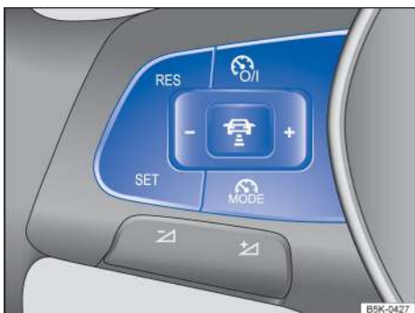
Рисунок 90. Левая сторона многофункционального рулевого колеса: кнопка управления ограничителем скорости
