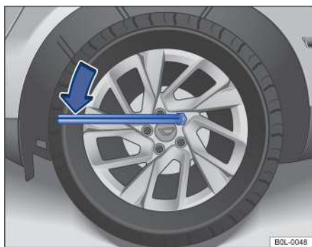
Рисунок 151. Замена колеса: откручивание колесных болтов
