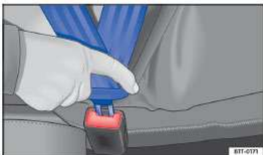
Рисунок 22. Вставьте язычок замка ремня безопасности в замок ремня безопасности
