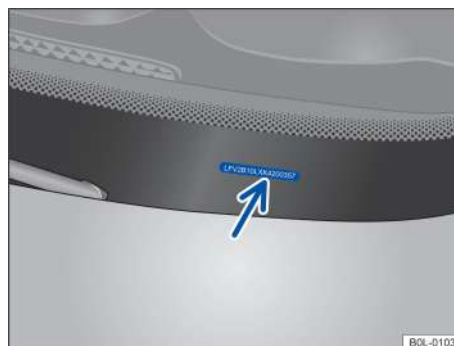
Рисунок 160. На лобовом стекле: Идентификационный код автомобиля
