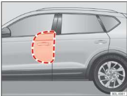
Рисунок 28 . Левая сторона автомобиля: зона действия боковой подушки безопасности
