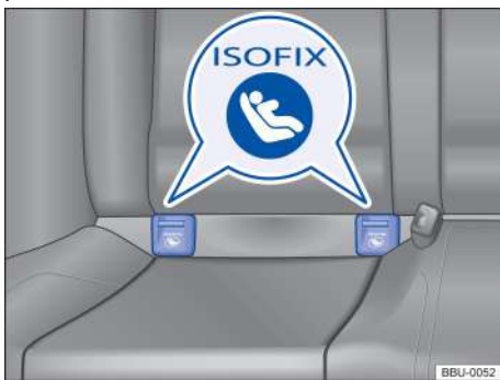
Рисунок 33. На автомобильном сиденье: маркировка крепления детского кресла ISOFIX
