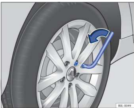
Рисунок 154. Замена колеса: снимите колесные болты с помощью торцевого ключа для колесных болтов
