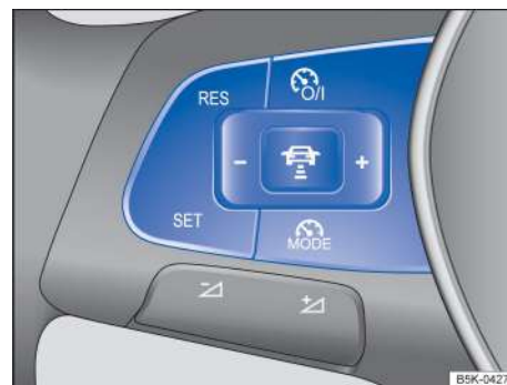
Рисунок 94. Левая сторона многофункционального рулевого колеса: кнопка управления АСС
