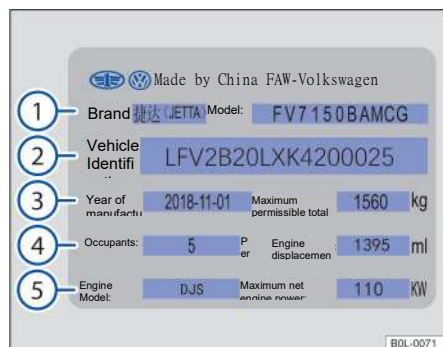
Рисунок 158. Паспортная табличка модели (схематическое изображение)
