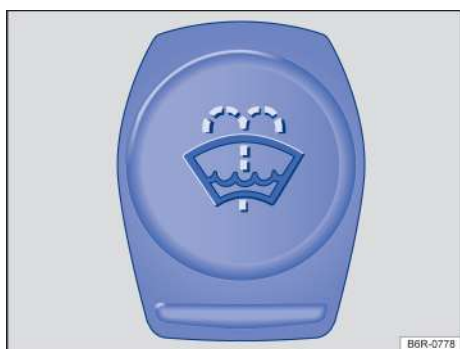
Рисунок 134. В моторном отсеке: крышка бачка стеклоомывателя
