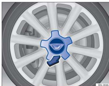
Рисунок 149. Снятие центральной накладки колеса
