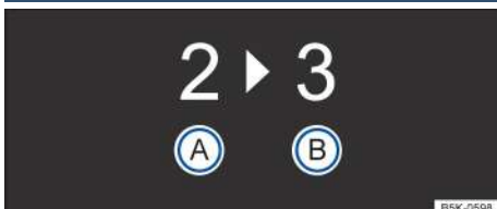
Рисунок 78 На дисплее приборной панели: предложения по включению передачи (Схематическое изображение)
