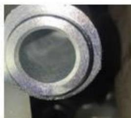
Отсутствие смазки в отверстии под штифт неисправной детали
