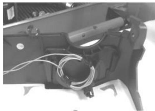
Штатный считыватель расположен внутри кожуха рулевого вала. На автомобиле можно применять различные варианты подключения обходчика иммобилайзера и использовать разные виды обходчиков. Рекомендуется использовать обходчик CARMEGA BIS-140. При использовании обходчика иммобилайзера CARMEGA BIS-140, петля из 5-7 витков (из штатного провода из комплекта обходчика) размещается вокруг штатного считывателя. Внутренний переключатель В обходчике необходимо установить в положение «PCB ANT».
