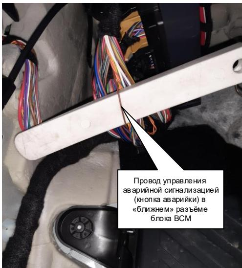
Подключите желтый/синий провод Системы Scher-Khan к коричнево/красному проводу кнопки аварийной сигнализации.
