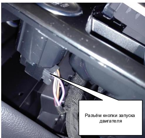
Подключение можно выполнить в разъёме кнопки запуска двигателя, расположенной в центральной консоли.
