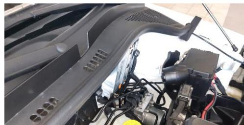
Для подключения сирены необходимо привести в моторный отсек коричневый провод центрального блока системы Scher-Khan и соединить его с красным проводом сирены.
