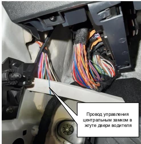
Подключение к кнопке управления центральным замком, в этом случае открытие/закрытие центрального замка системой Scher-Khan будет возможно только если не использовался штатный ключ автомобиля. Подключите фиолетовый провод (общий контакт реле) к сине/желтому проводу от кнопки управления центральным замком, а фиолетово/белый провод (Н.Р. Контакт реле) к «Массе».
