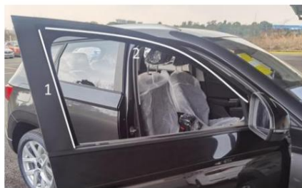
Нанесите масло на U-образную направляющую после того, как окно будет полностью опущено.
