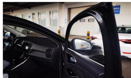
Опустите окно наполовину, нанесите масло вдоль зазора между внутренней планкой и стеклом.
