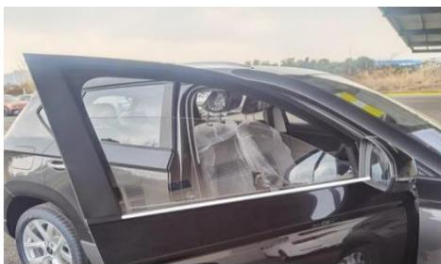
Опустите окно наполовину и нанесите масло вдоль внешней рейки.
