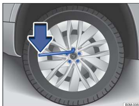
Рисунок 129. Замена колеса: ослабление колесных болтов
