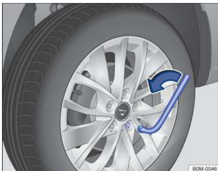
Рисунок 132. Замена колеса: снимите колесные болты с помощью торцевого ключа для колесных болтов.
