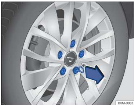
Рисунок 127. Снятие защитного колпачка колесного болта
