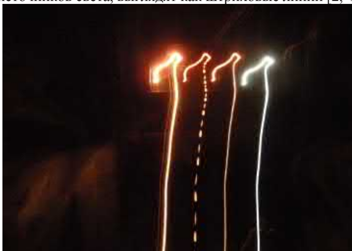
Рис. 4. Фотография различных источников света, сделанная с помощью цифровой камеры NIKON COOLPIX P50 при движении оси объектива сверху вниз: источники света (слева направо): 1) лампа накаливания 6,3 В×0,3 А ( U = 4,2 В, P = 0,84 Вт); 2) неоновая лампа (тиратрон тлеющего разряда МТХ-90) ( U = 175 В, питание от сети 220 В через резистор R = 90 кОм); 3) лампа накаливания 6,3 В×0,3 А ( U = 2,5 В, P = 0,30 Вт); 4) люминесцентная ртутная лампа LPO 3036 с электронным блоком питания; все лампы питаются переменным током с частотой 50 Гц.
