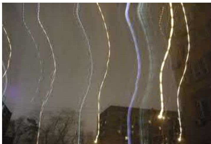
Рис. 5. Фотография уличных ламп, полученная при движении камеры. Жёлтые следы – свет натриевых ламп, белые и голубоватые следы – свет люминесцентных ламп, питаемых через электрические дроссели.
