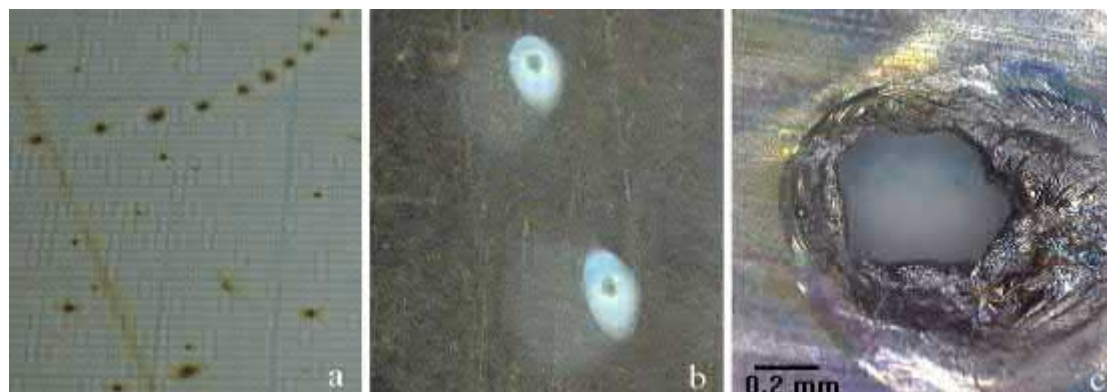
Рис. 3. Следы и повреждения, оставленные скачущими шариками на различных материалах: (а) – на координатной бумаге; (b) – на поверхности гетинакса; (с) – на алюминиевой фольге толщиной 9 микрон
