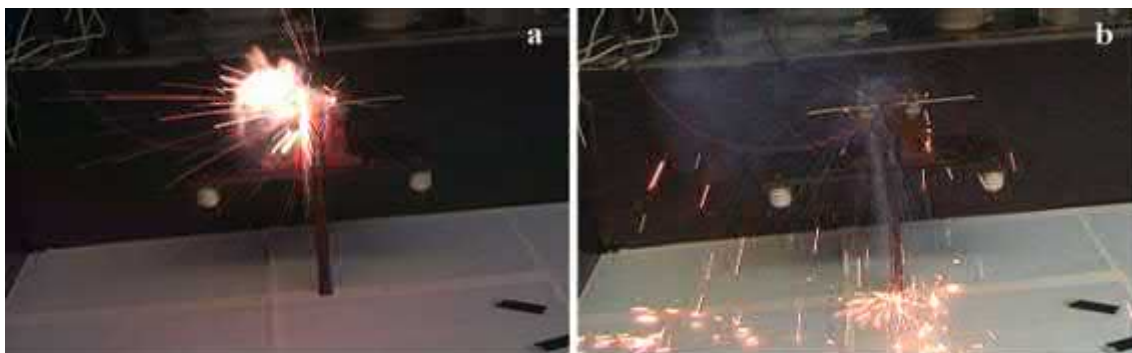
Рис. 1. Кадры видеозаписи одного из экспериментов по получению «скачущих шариков», снятые через ~20 мс (а) и ~280 мс (б) после обрыва тока (для снимка (б) проведена коррекция яркости, чтобы показать аэрогелевые «хвосты», тянущиеся за объектами)
