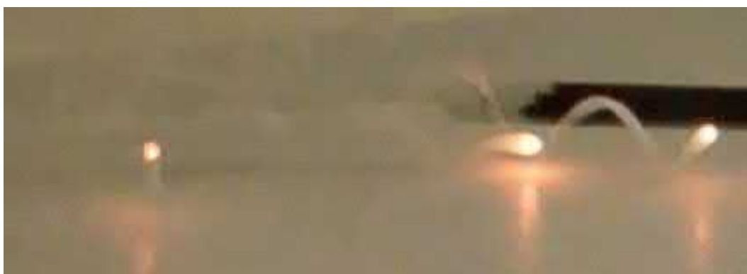
Рис. 2. Кадр скоростной видеозаписи, показывающий скачущие шарики крупным планом (1080 мс после обрыва тока)
