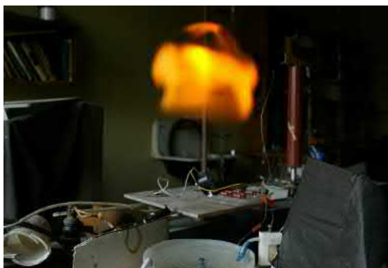
Рис. 2. Оболочка аналога шаровой молнии в процессе разрушения
