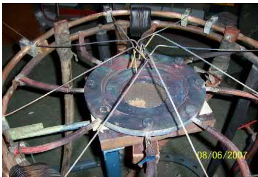
Рис. 3. Последствия взаимодействия ДПО с электродами и фанерой
