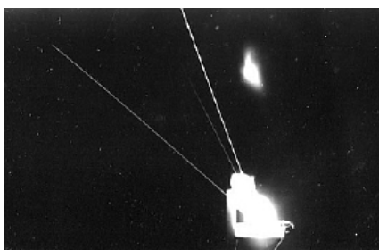
Рис. 2. Фотография капиллярного разряда и светящихся областей (СО)
