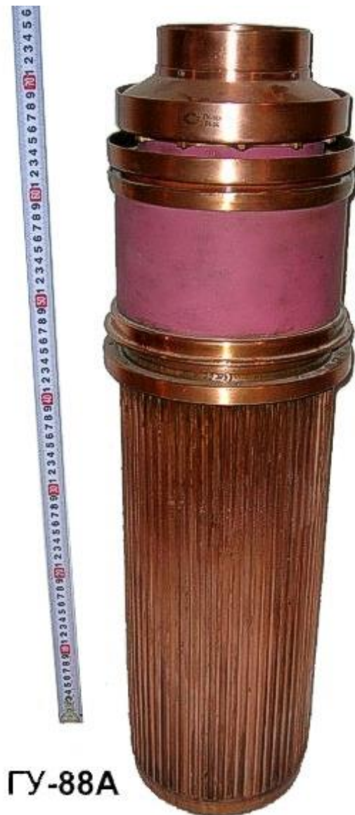
Рис. 1.7. Радиолампа мощностью 500 кВт
