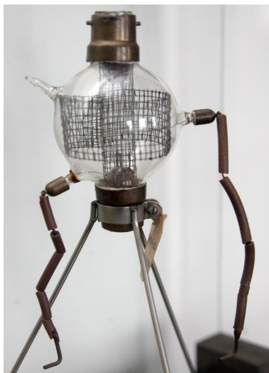
Рис. 1.6. Первая в мире радиолампа с водяным охлаждением
