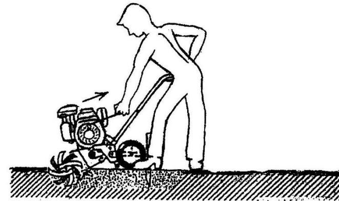
**Рис. 7. Положение МК и оператора при запуске двигателя**
