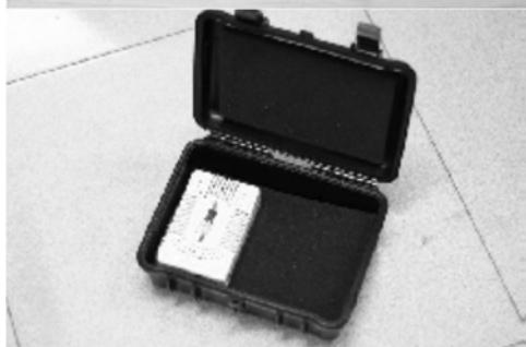
Специальный бокс с электроподогревом для прокаливания силикагеля
