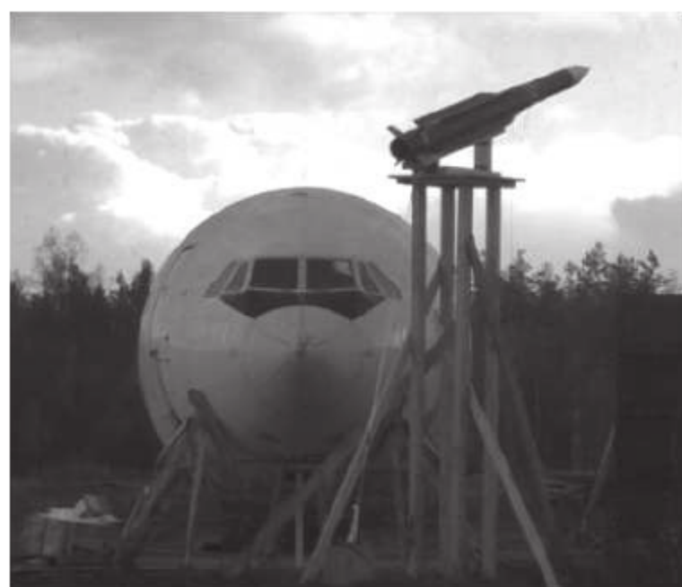
Рисунок 5. Целевая установка второго эксперимента, воссоздающая условия, указанные в DSB
