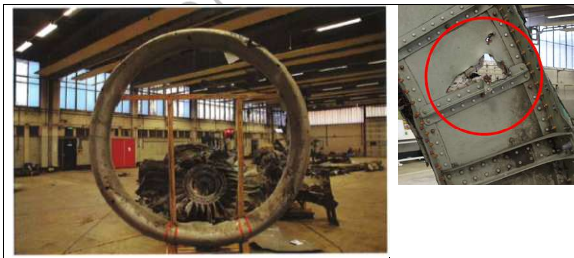
25 Рис. 14. Поврежденная передняя кромка левой гондолы двигателя (слева) и следы ударов 26 в положении 200 градусов, показанные сзади (справа) (Источник: DSB)
