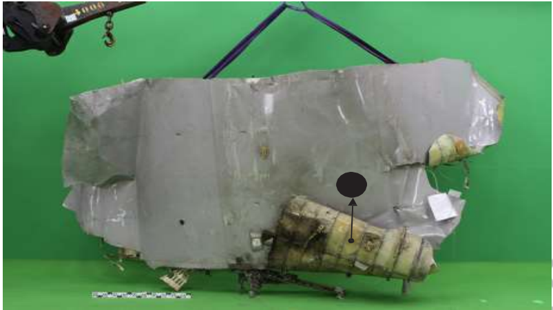
Рисунок 55 – Пример изгиба/отслоения на линии разлома, расположенной вдоль STA655, связанной с окончательным разделением двух частей обломков.
