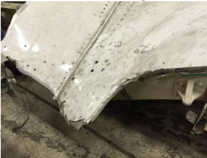
Рисунок 59 – Разрыв от перенапряжения при растяжении в правом верхнем углу пассажирской двери 3L
