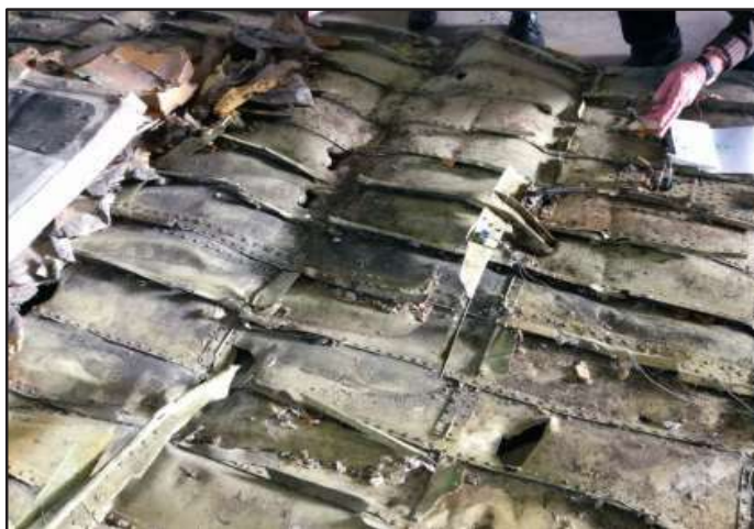
Рисунок 57 – Пример сильного коробления нижней панели обшивки фюзеляжа возле STA487.
