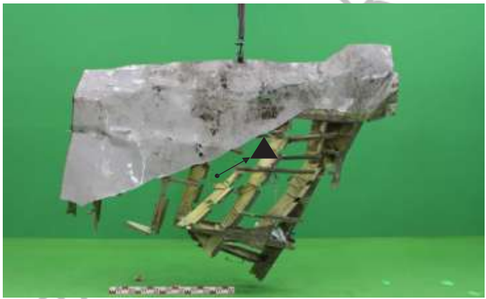
Рисунок 56 – Пример разделения обшивки и каркаса в носовой части непосредственно перед дверью 1R.
