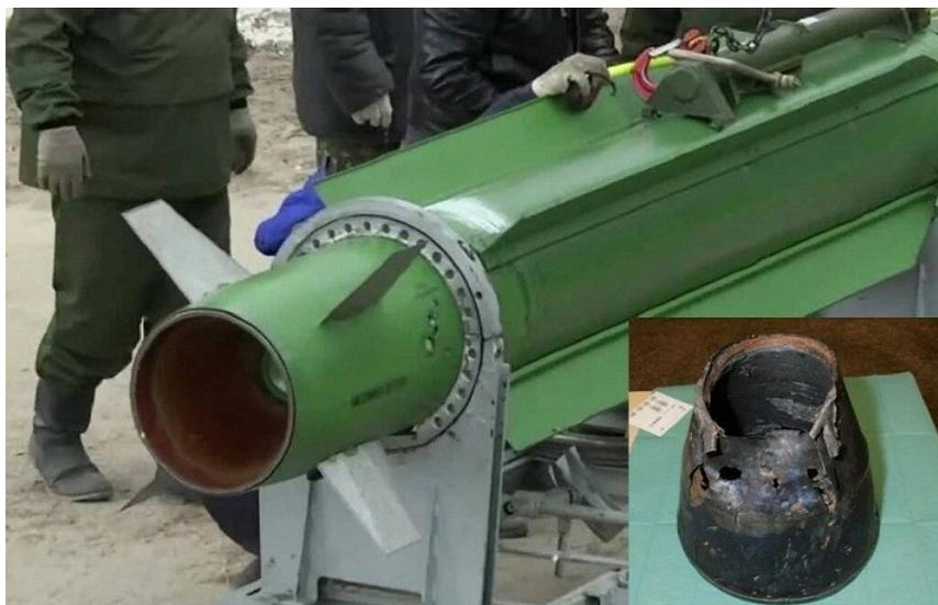
Состояние установленного на ракете сопла не отличается от неотстрелянных, складских ракет - **воронка сопла**, как видно по кадру, подернута ржавчиной, что для ракеты 1987 года вполне нормальное явление. При реальном "прожиге" никакого рыжего налета на воронке сопла не было бы. В глубине её также видна **чистая блестящая деталь**, что тоже указывает на невыжигание двигательной установки.
