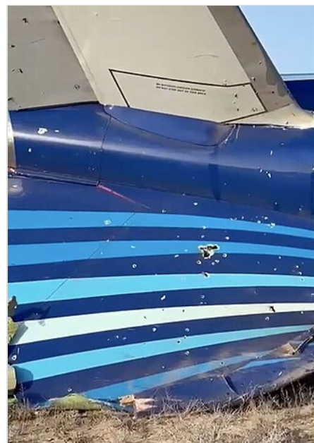
Характерные отверстия в хвостовой части обломков самолёта, которые, как отмечают эксперты, могли быть вызваны поражающими элементами ракет средств ПВО [18][19][125]
