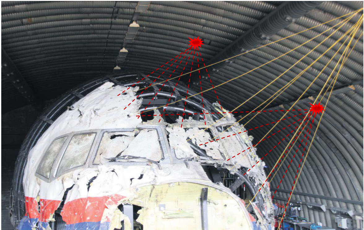
Рис. 35. Примерное расположение мест подрыва двух ракет «воздух-воздух», образовавших два поля накрытия кабины экипажа поражающими элементами. Натянутые шнуры жёлтого цвета: попытка комиссии DSB объяснить образование поля накрытия подрывом одной ракеты ЗРК типа БУК на достаточно большом расстоянии
