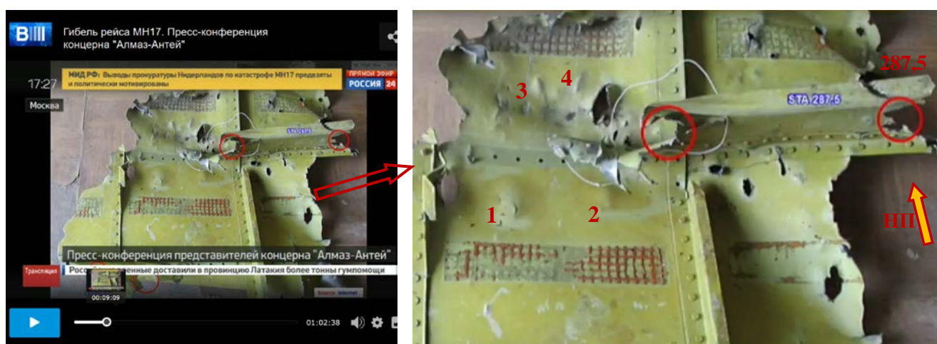
Рис. 22. Фрагмент «крыша 2» с пробоинами и значительными деформациями обшивки в районе шпангоута STA 287,5. Пробоины образованы при подходе поражающих элементов под большим углом к обшивке. а – из фильма «МН17: Год Молчания». б – внутренняя сторона «крыши 2» в районе шпангоута 287,5 ( пресс конференция «Алмаз-Антей» 28.09.2016 )
