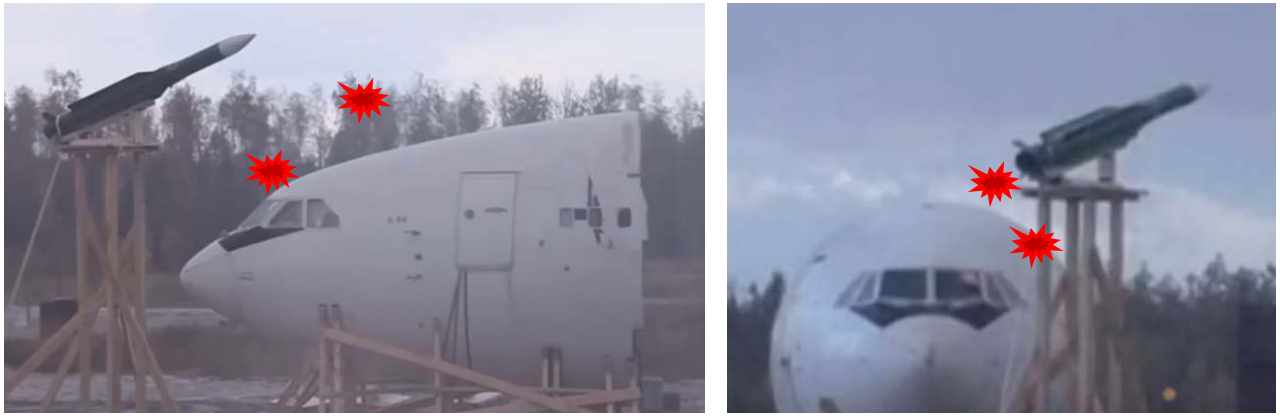
Рис. 38. Передняя секция самолёта Ил-86 и ракета 9М38М1 ЗРК БУК-М1, подготовленные к эксперименту «Алмаз-Антеем». Отмечены места подрыва двух ракет «воздух-воздух», определённые относительно кабины экипажа Боинга 777-200 9М-MRD
