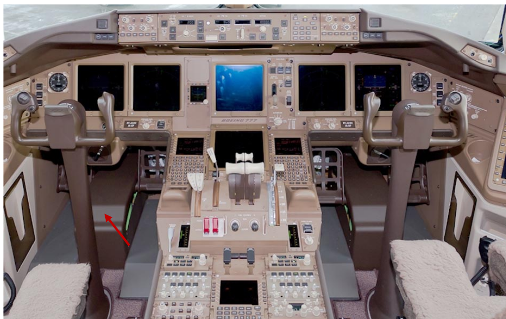
Рис. 27. Вид на нижнюю часть кабины . Стрелкой показан педальный узел
