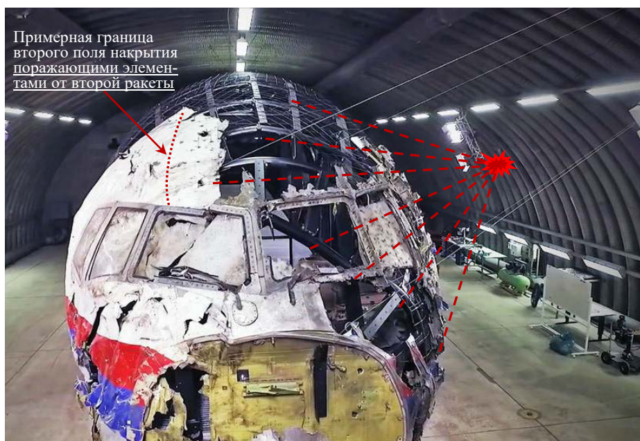
Рис. 6. Вид спереди на макет кабины экипажа с обозначенным примерным местом подрыва ракеты «воздух-воздух» с левой (по полёту) стороны на расстоянии от окна \approx 1,6 м
