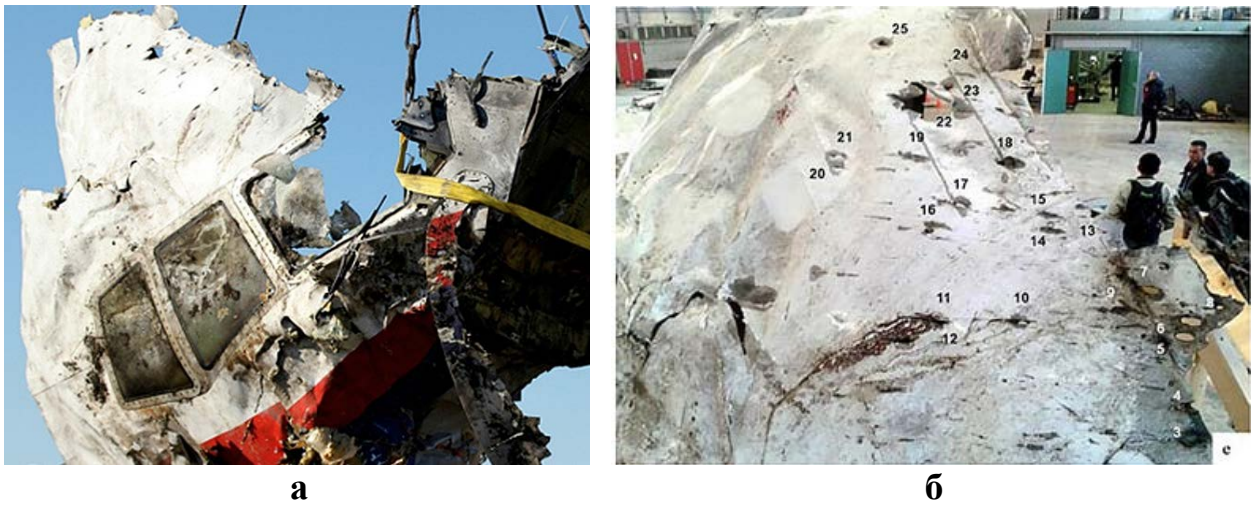
Рис. 10. На обшивке верхней правой части кабины имеются признаки наложения двух полей накрытия поражающими элементами от подрыва двух ракет «воздух-воздух»: пробоины – от одной ракеты, следы скольжения по касательной – от другой ракеты. а – фотография из интернета. б – иллюстрация из Доклада
