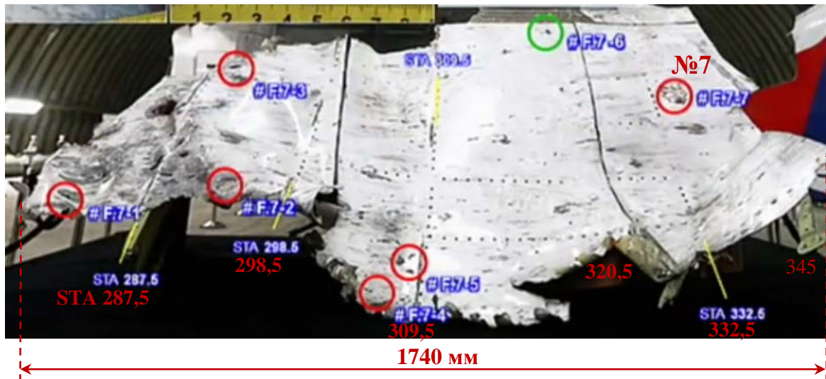
Рис. 23. «Крыша 2». Красными числами обозначены номера шпангоутов. Внутри красных кругов, – пробоины. Пробоина №7 возле шпангоута 332,5 находится возле правой границы поля накрытия поражающими элементами от подрыва ракеты над «крышей» и «крышей 2» в районе шпангоута 287,5
