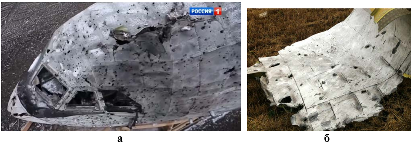
Рис. 39. Эксперимент «Алмаз-Антея» (а) и «крыша» самолёта Боинг 777-200 9М-MRD (б)
