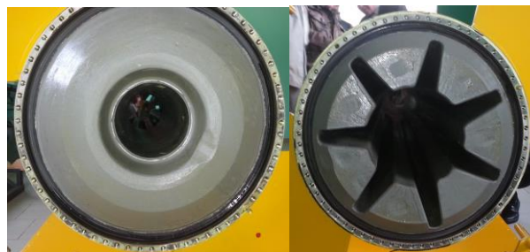
Рисунок 33 –БУК, передняя и задняя части топливного зерна
