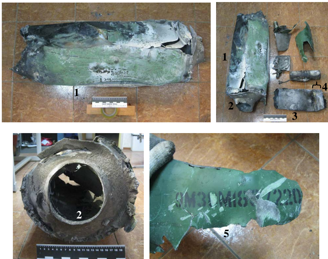
Рис. 60. Фрагменты ракеты 9М38М1. 1 – корпус двигателя с прогоревшей передней частью, раскрывшимися трещинами и отложениями продуктов сгорания на его поверхности. 2 – заднее днище. 3 – газовод, 4 – цилиндрическая часть сопла, не отделившаяся от газовода. 5 – фрагмент корпуса ракеты с её номером без последней цифры
