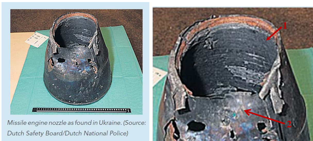
Рис. 62. Сопло двигателя ракеты, найденное на Украине (стр. 82 Окончательного отчёта). 1 – вставка сопла с сохранившимися кольцевыми бороздками и не имеющая признаков нагрева до температур работы двигателя. 2 – вмятина на корпусе сопла с пробоинами от удара агрегатами четвёртого отсека ракеты
