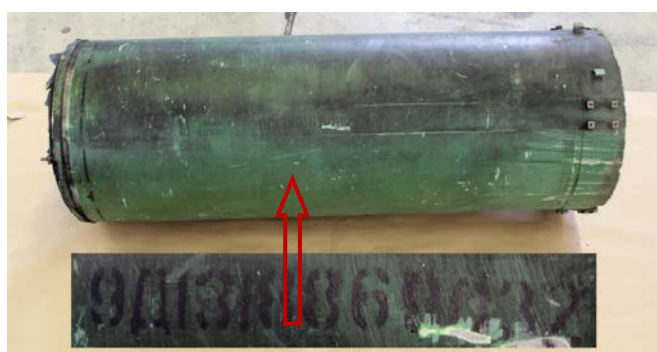
Рис. 57. Корпус двигателя №9Д1318869032 с копотью на поверхности, подтверждающей факт подрыва БЧ ракеты
