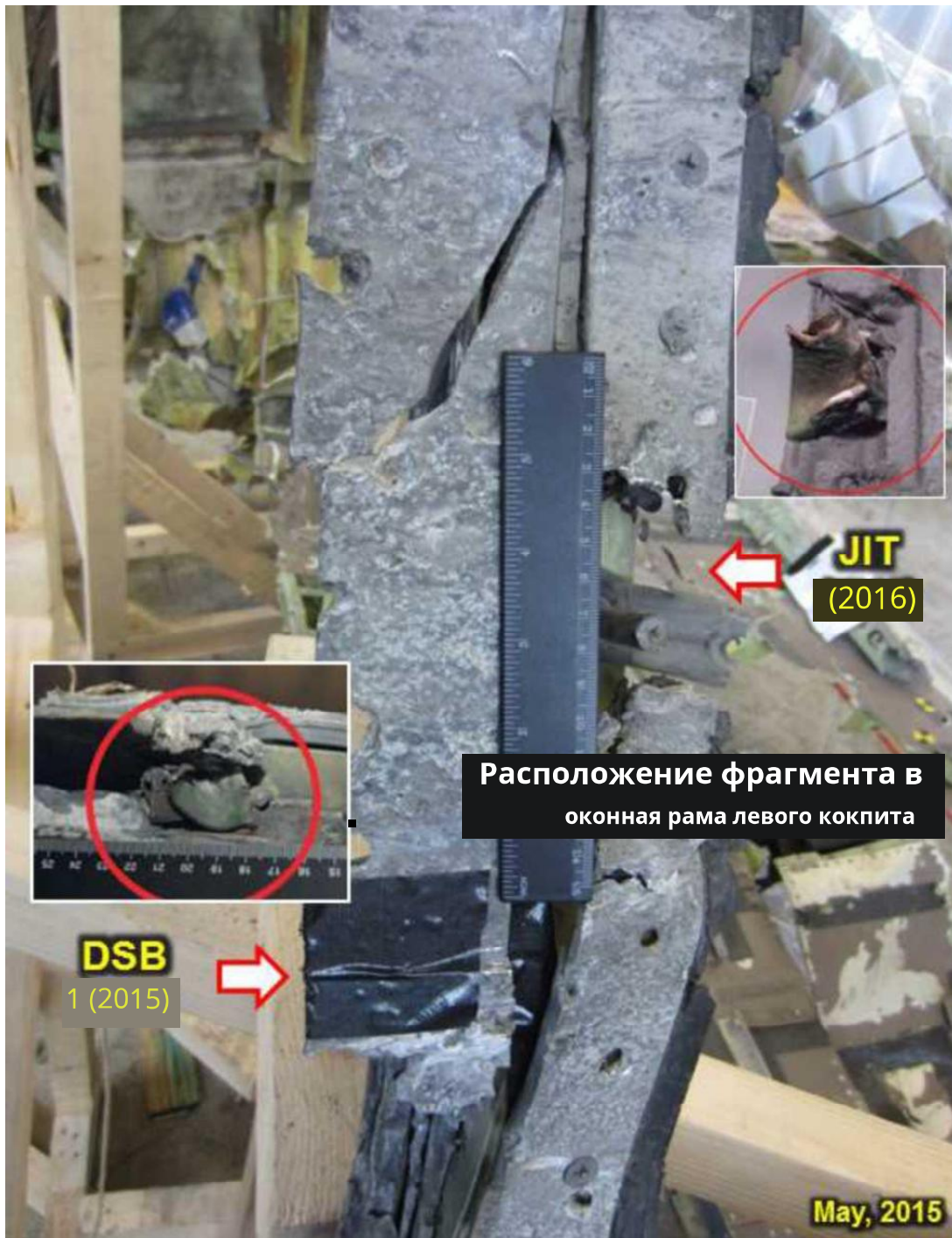
Рисунок G.5.3 – Два разных места обнаружения «металлических осколков» под прижимной планкой второго окна командира воздушного судна (DSB, 2015 г.); в третьем разрыве оконной рамы (JIT, 2016)
