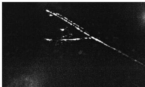
Рис. 2. След траектории частицы в смоле, залившей трещину в дереве. (на рисунке не проявились шарообразные прозрачные капли)
