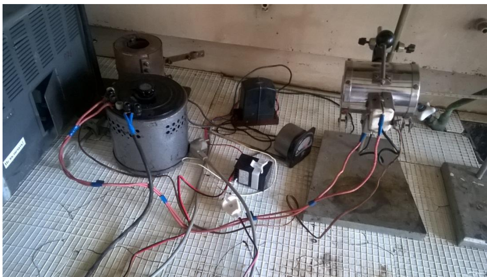
Рисунок 12 – Установка для исследования процесса изменения массы лесных горючих материалов
