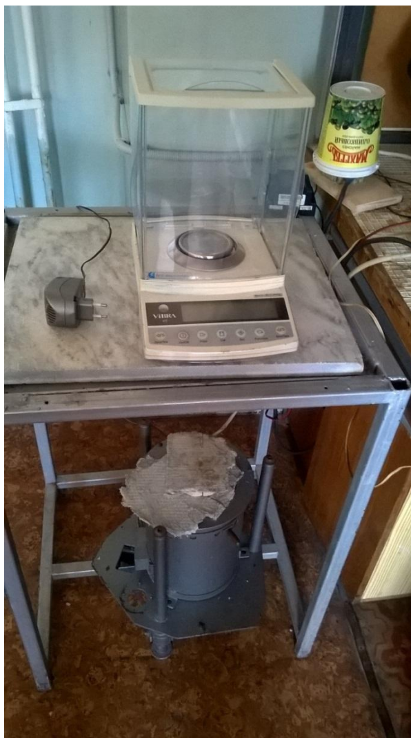
Рисунок 8 – Установка для исследования поведения лесных горючих материалов при длительном воздействии температуры
