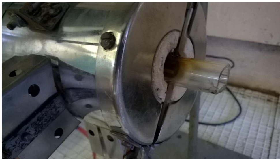
Рисунок 13 – Конденсация летучих при горении лесных горючих материалов в кварцевой трубке
