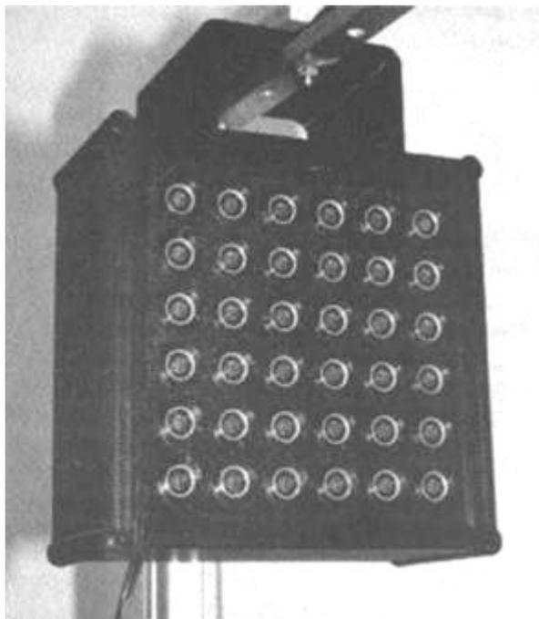
*Рис. 67. Излучатель из 36 VCSEL-лазерных диодов типа LT (линейный лазер), укрепленный на штативе.*
