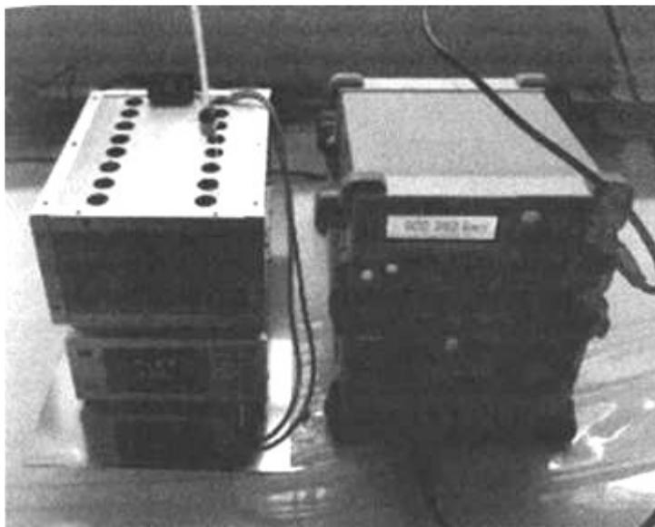
Рис. 85. Установка для калибровки индикаторов давления с сенсором «Honeywell 26PCCFA6G» ( $V_{cc} = 15$  В).
