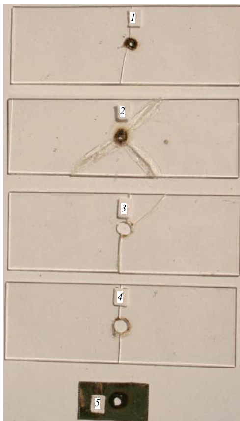
Рис. 3. Вид отверстий после прохождения шаровой молнии: 1 и 2 — отверстия диаметром 2 и 3 мм с оплавленными краями в стеклянной пластинке толщиной 1 мм при разрядном токе соответственно 25 и 50 А; 3 — отверстие с ровными краями диаметром более 5 мм, полученное после удаления оплавленного ободка у отверстий 1 и 2; 4 — отверстие, полученное в стеклянной пластинке ещё до разряда имелось малое (диаметром около 0,5 мм) отверстие; 5 — отверстие диаметром 4 мм в металлической пластинке толщиной 0,5 мм.
