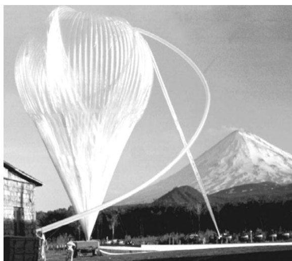
Рис. 6. Подготовка российского АДА с магнетометром к запуску на Камчатке в 1997 г. Идет закачка газа по специальным рукавам – «аппендиксам» от резервуаров с гелием, которые видны на заднем плане. Полезная нагрузка – 2т специального оборудования для сверхточных магнитных измерений. Летом такой АДА летит в устойчивом воздушном течении со скоростью около 50 км/ч. В зимний период скорость 150 км/ч, но трассы полета менее устойчивы по направлению
