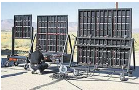
Рис. 2. Щиты на дороге, испускающие инфразвук
