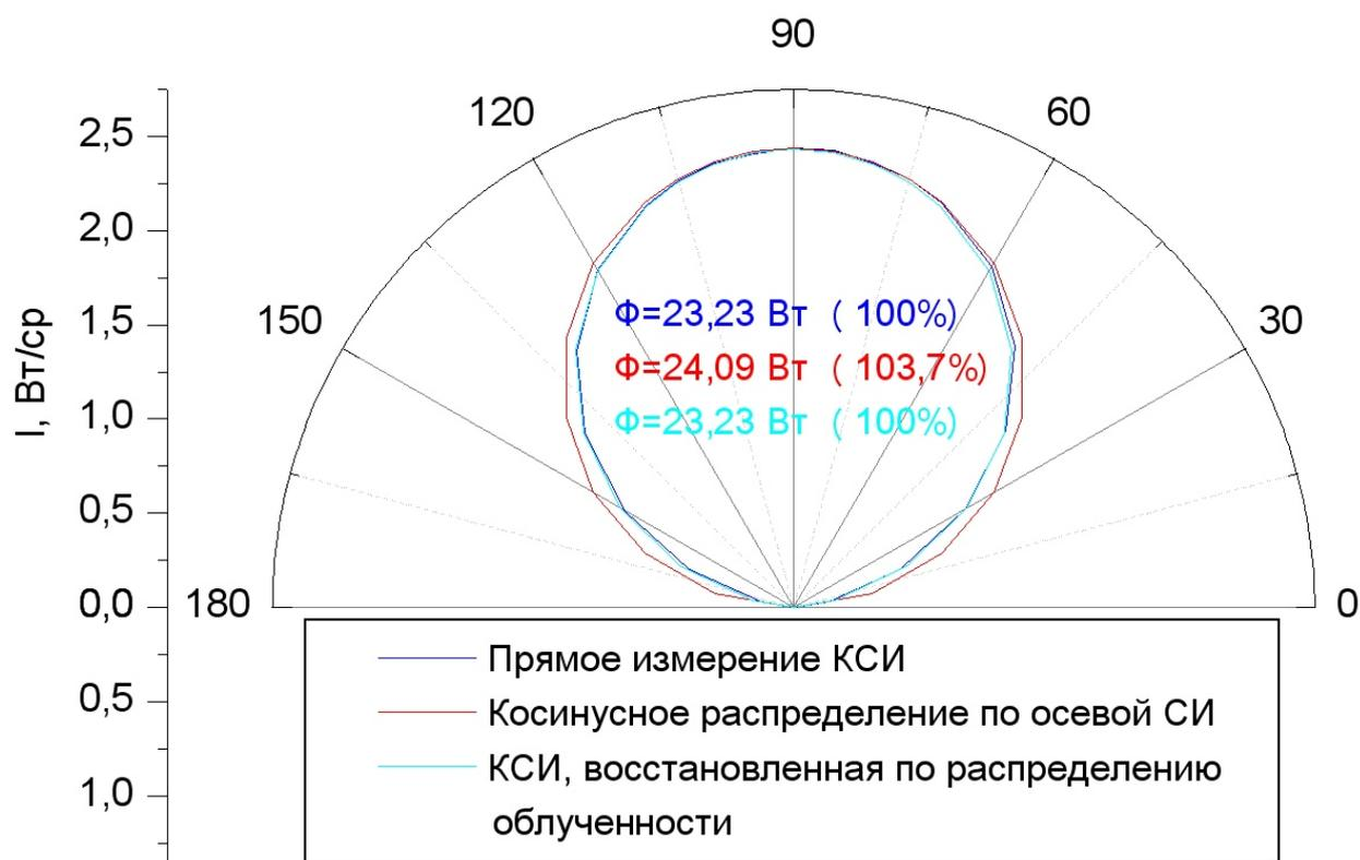
*Рис. 2.9 КСИ лампы в начале срока службы, полученные с помощью прямого измерения, косинусной аппроксимации и из распределения облученности.*
