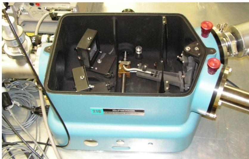
*Рис. 2.11 Вакуумный монохроматор McPherson 218.*
