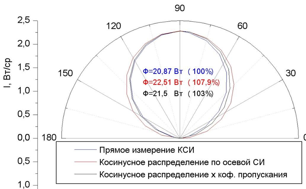
Рис. 2.4 КСИ лампы после 600ч горения, полученные 3 различными способами.
