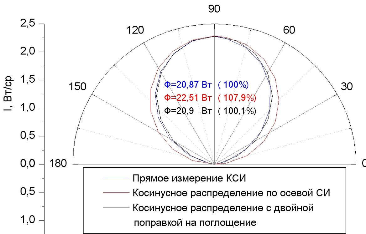
Рис. 2.5 КСИ лампы после 600ч горения, полученные 3 различными способами
