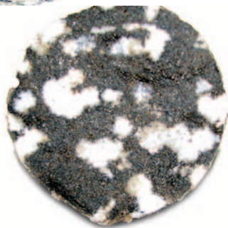
Рис. 2. Песчаник нефтенасыщенный, с гипсовыми округлыми включениями, бобриковские отложения, глубина образца 1164,0 м.
