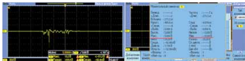
▲ Рис. 4. Осциллограмма образца песчаника № 45 во время испытания при динамическом приложении нагрузки
